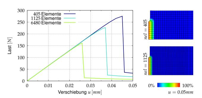
Für die regularisierte Formulierung ergibt sich eine eindeutige Last-Verschiebungs-Kurve, die Netzabhängigkeit ist behoben. Die Streuung der Schädigung auf eine größere Fläche führt auf eine höhere Maximallast, die die tatsächliche Last überschätzen kann. Das duktile Entfestigungsverhalten ist abbildbar.
