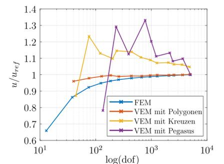
Es ist zu erkennen, dass die Wahl der  $\mathbf{S}$ -Matrix und die Wahl des Netzes das Konvergenzverhalten beeinflussen. Bei der Tesselation (Kreuz, Pegasus) werden verwertbare Ergebnisse erst bei einer hohen Anzahl an Freiheitsgraden erreicht.
