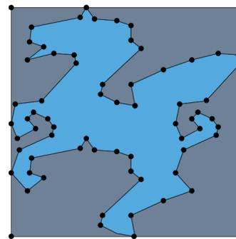
Aufgrund der vielseitigen Elementgeometrien, welche bei der VEM verwendet werden können, wurden auch in dieser Arbeit sehr unterschiedliche Netze als Diskretisierungsgrundlage eingesetzt. Dies reicht von klassischen Rechtecknetzen zu Schriftzügen, Polygonen bis zu der sogenannten Parkettierung, bei der das Verschieben einer Elementgeometrie ein Netz entstehen lässt.
