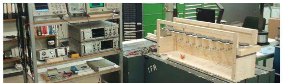
Am selbst gebauten Modell wurden die Eigenfrequenzen und Eigenformen am Institut für Mechanik ermittelt und ausgelesen. Zur Bemessung mit RSTAB wurde ein Brückenmodell entworfen, welches so oder in ähnlicher Form auch realisiert werden kann. Neben der Bestimmung der Eigenformen und Eigenfrequenzen war hier der Vergleich von Spannvariationen Ziel der Untersuchungen.
