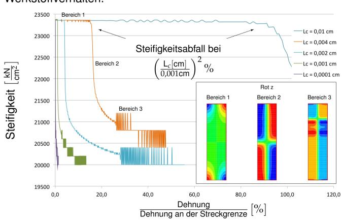
Im Bereich 2, dem Steifigkeitsabfall, und Bereich 3, der reduzierten Steifigkeit, ist in der Umgebung um die größten Rotationsgradienten eine lokale Einschnürung der Probe festzustellen. Maßgebend für den Steifigkeitsabfall ist eine Grenzrotationsintensität. Deren Auftreten ist direkt von dem Cosseratparameter L<sub>c</sub> abhängig.
