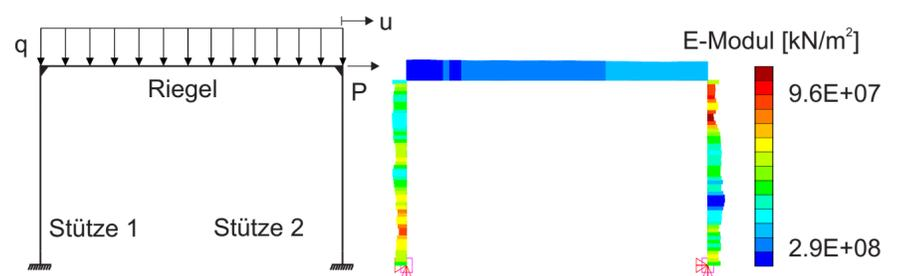
Als numerisches Beispiel wird ein biegesteifer Rahmen betrachtet und die stochastische Verteilung der Verschiebung  $u$  untersucht. Ein korreliertes E-Modulfeld  $[kN/m^2]$  wird mit verschiedenen Korrelationslängen pro Bauteil auf die Knoten des FE-Netzes generiert.
