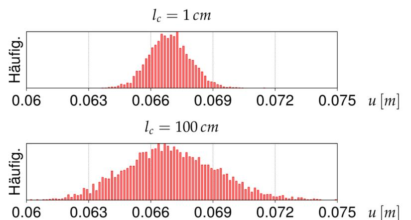
Mit der Monte-Carlo-Simulation werden statistische Attribute der Systemantwort angenähert. Durch die Zunahme der Wahrscheinlichkeit extremal gemittelter E-Module über den Stab steigt die Streuung mit Erhöhung der Korrelationslänge. Bei Verwendung eines geometrisch nichtlinearen Verzerrungsmaßes werden die Verschiebungen im Falle einer Zugbeanspruchung geringer. Durch diesen Versteifungseffekt verringert sich die Streuung der Systemantwort und die Verteilung wird unsymmetrisch.
