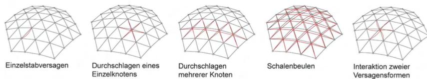
In dieser Arbeit war insbesondere die mögliche Kopplung bzw. Interaktion mehrerer Versagensmodi zu untersuchen, da sie die Imperfektionssensitivität des Tragwerks deutlich erhöhen kann. Die Arbeit entstand in Kooperation zwischen dem Institut für Baustatik des KIT und dem Ingenieurbüro schlaich bergemann und partner, Stuttgart.
