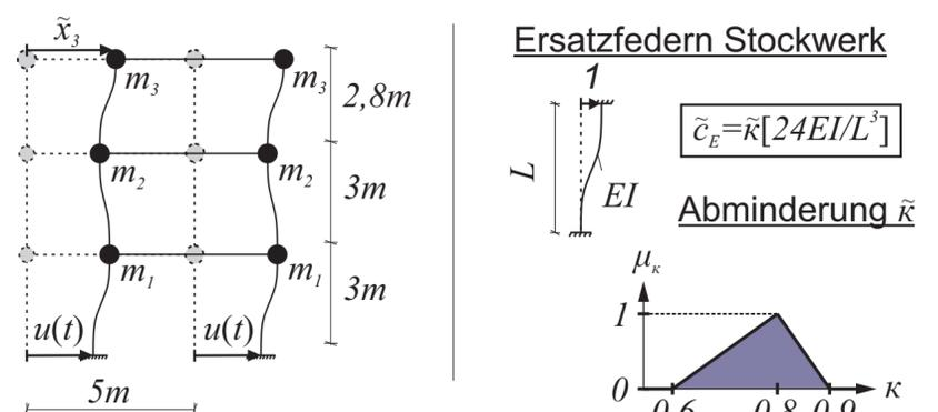
Abbildung 3: Modellierung des Stockwerkrahmens
