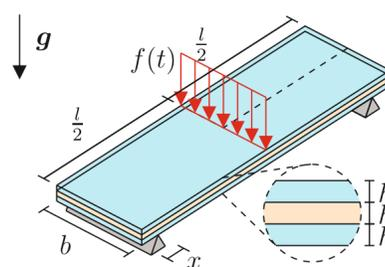
Zur Verifizierung wird das FE<sup>2</sup>-Modell eines Dreipunkt-Biegeversuchs betrachtet. Die Belastung wird innerhalb von 136 s linear aufgebracht und im Anschluss konstant gehalten (schwarz). Als Referenz dient eine Berechnung mittels eines
