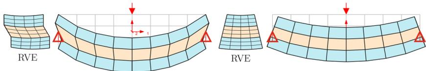
Mit dem zu Beginn der Arbeit zur Verfügung stehenden FE<sup>2</sup>-Modell nach Gruttmann und Wagner (2013) ist es nicht möglich den beschriebenen Abschervorgang auf lokaler Ebene zu erfassen, da infolge der globalen Schalenverzerrungen nur eine Querschnittsverformung des gesamten Laminats berechnet werden kann, und so die deutlich steiferen Glasscheiben die Deformation des Laminats bestimmen (Abb. rechts).
