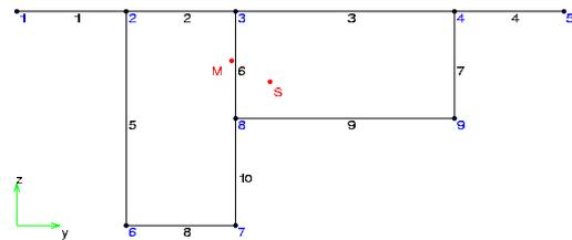
Abb. 2: Diskretisierter Querschnitt
