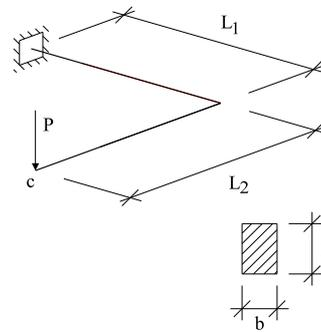
Als Beispiel dient ein abgewinkelter Kragarm mit einer Einzellast am freien Ende. Hier treten alle für das Trägerrostelement relevanten Größen ( $Q_z$ ,  $M_y$ ,  $M_T$ ) auf.
