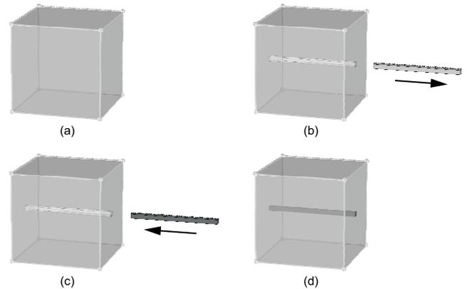
Abb. 2: Einbau der Faser
