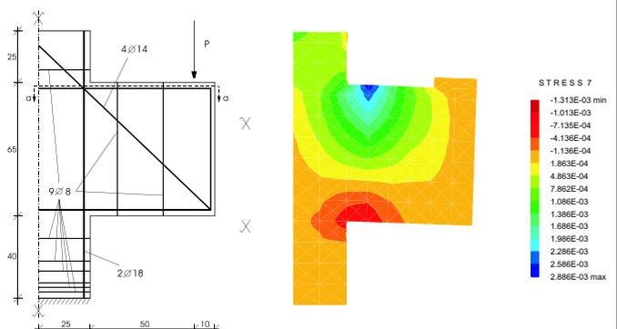
Abb. 3: Skizze und plastische Vergleichsdehnungen der Konsole
