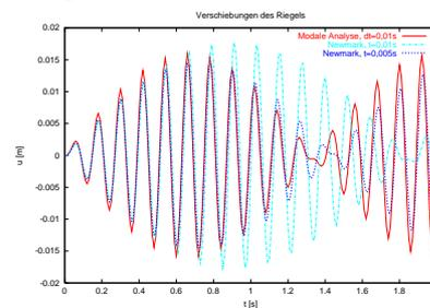
Abb. 1: Verschiebung des Riegels
