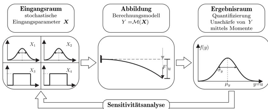
Die Unschärfe solcher Ausgangsgrößen kann mit Hilfe von statistischen Momenten quantifiziert werden. Zusätzlich kann mittels einer globalen Sensitivitätsanalyse der Einfluss der Eingangsvariablen auf die Unschärfe der Ausgangsgröße bestimmt werden. Die Monte-Carlo-Simulation (MCS) ist dabei eine gängige Methode, jedoch besitzt sie einen hohen Rechenaufwand. Eine zweistufige polynomielle Chaosentwicklung (PCE) kann diesen Rechenaufwand deutlich reduzieren.
