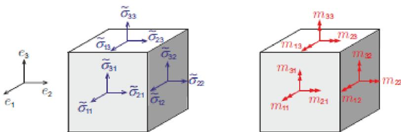
Abb.: Cauchywürfel mit Spannungen (links) und Momentenspannungen (rechts)
