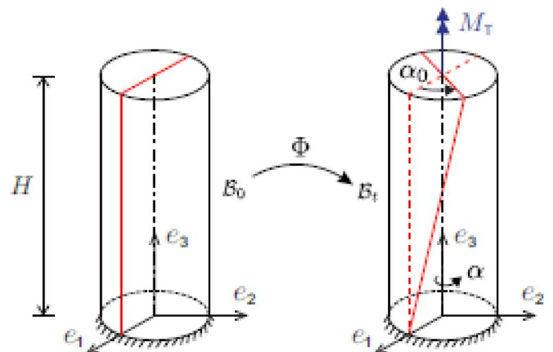
Abb.: Referenz- (links) und Momentankonfiguration (rechts) bei Torsion
