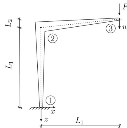
Die FE-Lösung des log. Voutenelements entspricht der einer analytischen Handrechnung. Somit wurde ein exaktes Modell mit einem Element pro Stab für beliebig komplexe Voutensysteme mit Rechteckquerschnitt implementiert. Die verbleibenden Modelle zeigen mit steigender Diskretisierung ein Konvergenzverhalten. Mit dem Ansatz des kommerziellen Programms wird allerdings eine höhere Diskretisierung benötigt, um brauchbare Ergebnisse zu erzielen.
