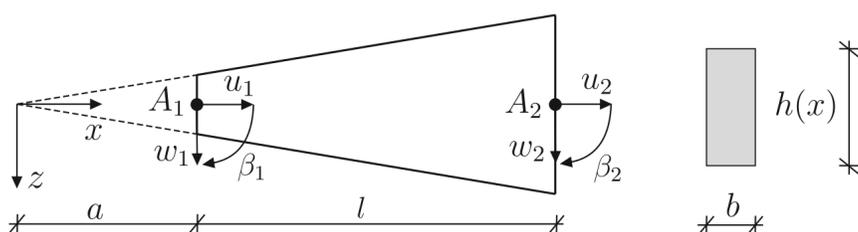
Nachfolgend sind die log. Ansatzfunktionen dargestellt. An der Antimetrie der Einheitsverschiebungszustände des beidseitig eingespannten Voutenelements wird der Einfluss der veränderlichen Steifigkeit auf die Gesamtverformungen des Systems verdeutlicht.
