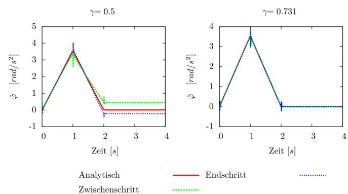
Bei Betrachtung der Winkelbeschleunigungen der Antriebsachse erhält man für den Wert  $\gamma = 0.731$  die besten Ergebnisse. Dieser Wert ist im Falle von nichtlinearen Berechnungen zu bevorzugen.
