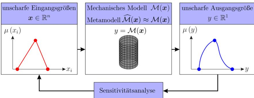
Die Unschärfen in den Eingangsparametern übertragen sich auf die entsprechende Ausgangsgröße, wie z.B. die Stabilitätslast einer Struktur. Mithilfe einer Sensitivitätsanalyse kann der Einfluss der Eingangsgrößen auf die Ausgangsgröße quantifiziert werden.
