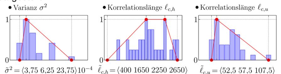
Das Ergebnis (li.) zeigt den Mittelwert der Beullast als Fuzzy-Ausgangsgröße. Die verschiedenen Metamodelle bilden die unscharfen Eingangsgrößen ähnlich auf die unscharfe Ergebnisgröße ab. Die Sensitivitätsanalyse (re.) zeigt, dass die Korrelationslänge  $\ell_{c,u}$  in Umfangsrichtung im Gegensatz zu den anderen Eingangsvariablen  $\sigma^2$  und  $\ell_{c,h}$  nur einen sehr geringen Einfluss auf den Mittelwert der Beullast aufweist.
