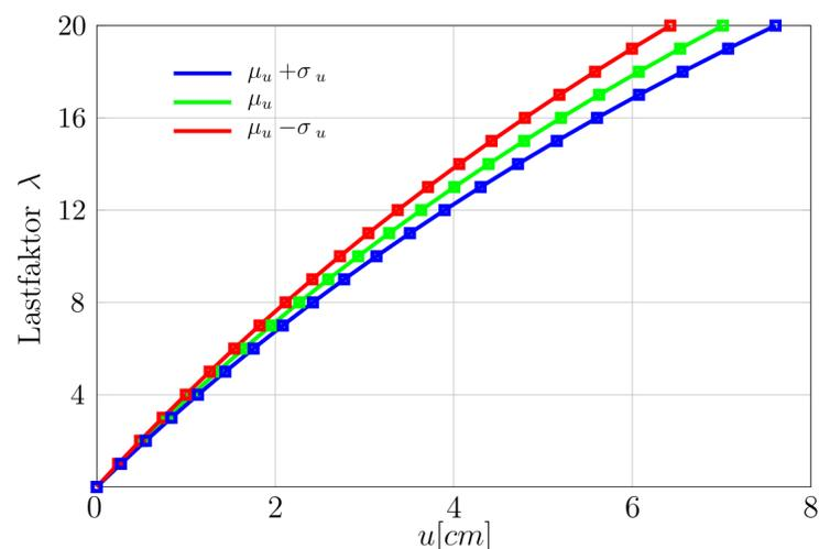
Aufgrund der geometrisch nichtlinearen Stabformulierung werden die Stützen infolge der Druckspannung weicher. Mit steigender Druckbelastung nimmt die Streuung der Verschiebung zu.
