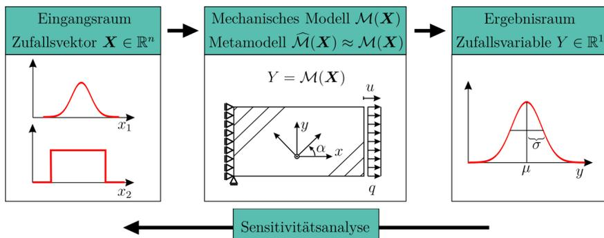
Die natürlichen Unsicherheiten der Eingangsgrößen übertragen sich auf die gesuchte Ausgangsgröße, wie etwa eine Verschiebung einer Struktur, welche sich abschließend durch stochastische Momente, wie Erwartungswert und Varianz, charakterisieren lässt. Mithilfe einer Sensitivitätsanalyse kann der Einfluss der Eingangsgrößen auf die Ausgangsgröße quantifiziert werden.
