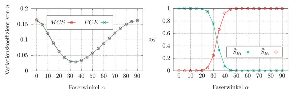
Der Variationskoeffizient (li.) besitzt bei einem Faserwinkel  $\alpha \cong 33^\circ$  sein Minimum. Aus der Sensitivitätsanalyse (re.) wird deutlich, dass bei diesem Faserwinkel ebenfalls die Einflüsse der beiden E-Moduln identisch sind. Es ist also zu beobachten, dass die Streuung bei zunehmender Überlagerung des Einflusses beider E-Moduln sinkt.
