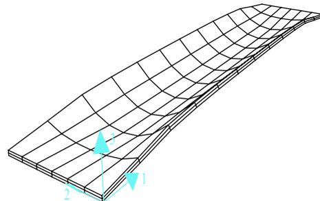
Abb. 2 Querkontraktion des Kreuzgewebes bei Zugbeanspruchung in 1-Richtung.
