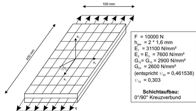
Abb. 1 Systemdaten des zugbeanspruchten Kreuzgewebes.
