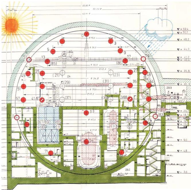
Temperatur- und Feuchtfühlerverteilung in einem Sicherheitsbehälter
